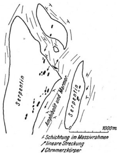
Abb. 61. Reihenförmige Anordnung der Chromerzkörper im Serpentinmassiv von Golemo Kamenjane und gleich gerichtete tektonische Streckung im Massiv und im Rahmen. (Nach W. E. PETRASCHECK.)
